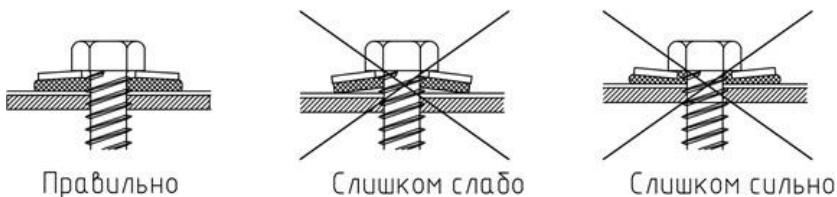
Рис. 8 Правильная затяжка самосверлящих шурупов
