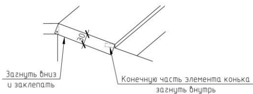
Рис. 22 Заведение элемента конька на маску кровли торцевую
