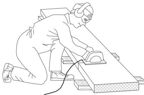
Рис. 1. Монтажная резка панелей
